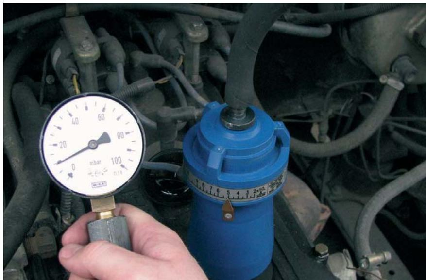
**Рисунок 2** – Измерение давления в картере бензинового двигателя
