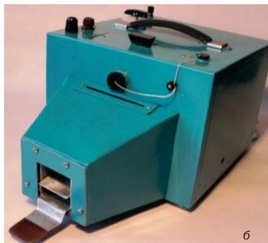
**Термогравиметрический влагомер ВСЛК-1М** а – схема; б – общий вид
