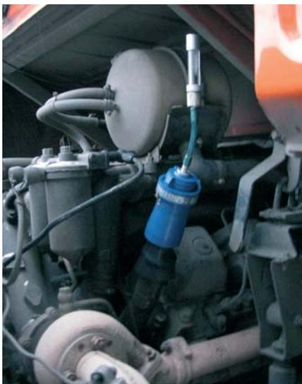
**Рисунок 1** – Измерение расхода картерных газов
