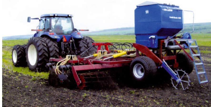
Сеялка дисковая мульчирующая СДМ-6x2П
