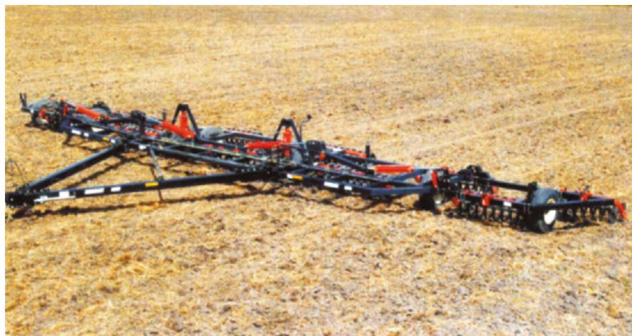
мер, культиватор Horsch TigerJIT с шириной захвата 5 м агрегатируется с тракторами мощностью более 370-420 л. с., поскольку агрегат насыщен разнообразными рабочими органами.
