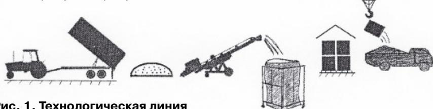
**Рис. 1. Технологическая линия контейнерной закладки зерна с использованием мобильных технических средств**
