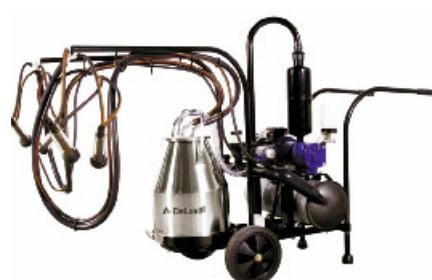
**Рис. 4. Мобильная доильная установка для коз и овец**
