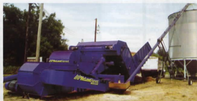
Рис. 3. Стационарный комбайн для выделения товарного зерна и незернового корма MX-230
