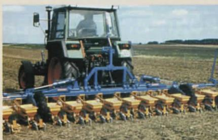
него опорного колеса. Параллелограммная конструкция крепления подвески высевающего аппарата позволяет точно копировать рельеф поля, за счет чего достигается
