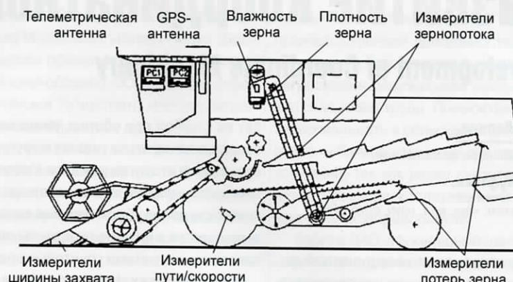
**Измерительное оснащение зерноуборочного комбайна для урожайного картирования**
