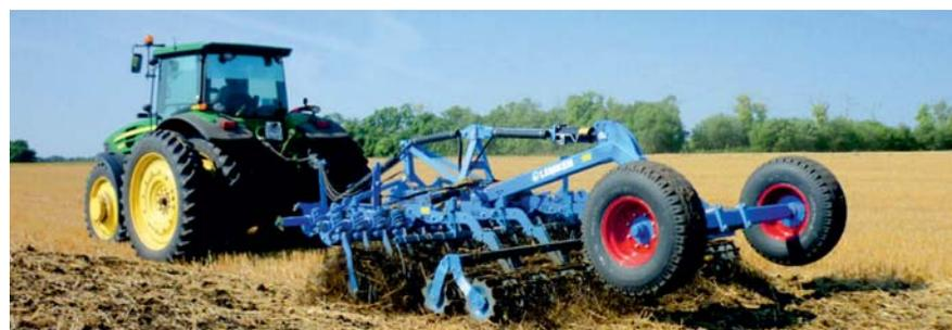
Рис. 3. Борона дисковая почвообрабатывающая Рубин 9/400 КУА в агрегате с трактором John Deere 7830 в работе
