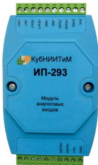
**Рис. 3. Модуль ввода аналоговых сигналов ИП-293**
