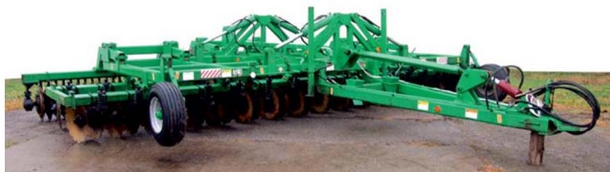
Рис. 1. Борона дисковая БДС-8 в рабочем положении
