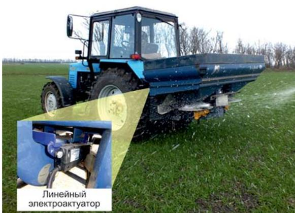
**Рис. 2. Разбрасыватель Vogballe M2, оборудованный системой «Агронавигатор-Асур-Дозатор», в агрегате с трактором Беларусь 1025.2**
