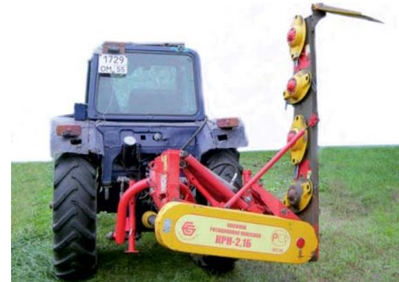
Рис. 2. Косилка ротационная КРН-2,1Б
