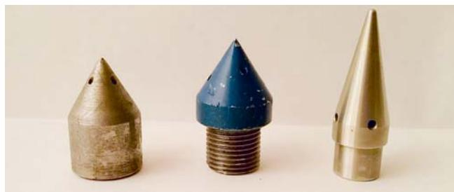
**Рис. 2. Сменные наконечники пневмогидробуров**
