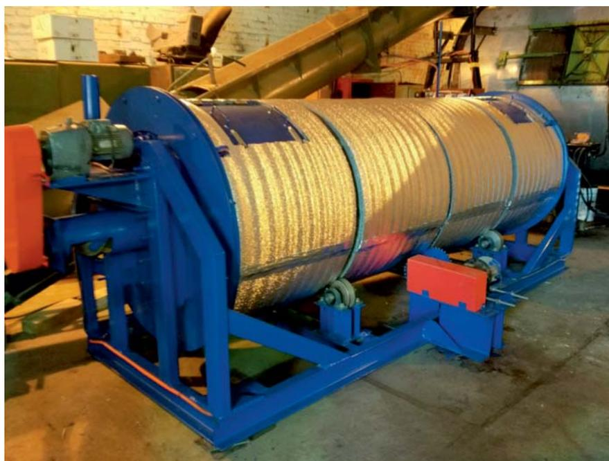
**Рис 2. Лабораторная биоферментационная установка барабанного типа**
