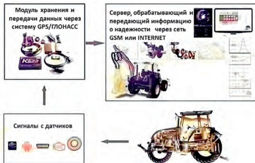
**Рис. 2. Сбор информации о работе систем тракторов с помощью параметров технического состояния**
