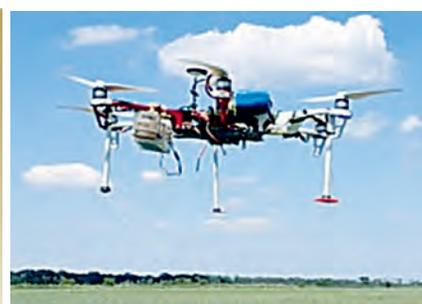
Рис. 2. Прибор ПСЛ-3, установленный на мультикоптере
