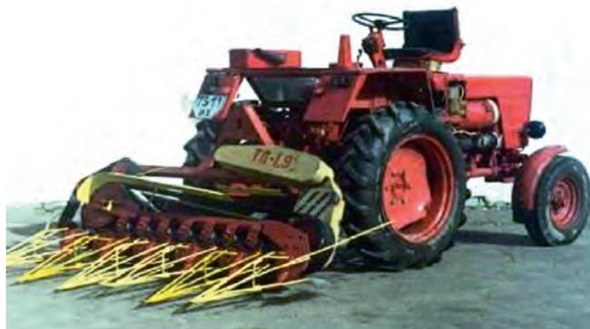
**Рис. 1. Общий вид одноярусных трехгранных делителей с верхним расположением компенсаторов, установленных на теребивильном аппарате льнотеребилки ТЛ-1,9**
