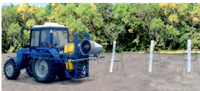
Рис. 4. Нанесение на карточки капель из воздушно-капельного потока, создаваемого подачей щелевыми распылителями факелов распыла подкрашенной жидкости в воздушный поток начального участка струи
