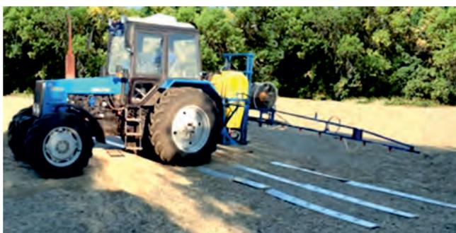
Рис. 3. Опрыскивание картошек щелевыми распылителями, установленными на навесной штанге опрыскивателя
