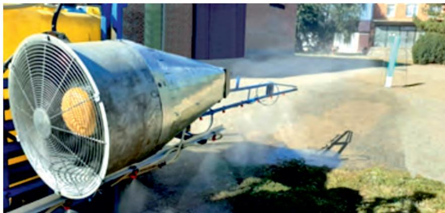
**Рис. 2. Качественная оценка распространения воздушно-капельной системы за пределы края штанги при работе навесного опрыскивателя**
