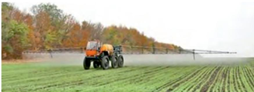
**Рис. 1. Самоходный штанговый опрыскиватель на краевой обработке поля от сорняков и вредителей**
