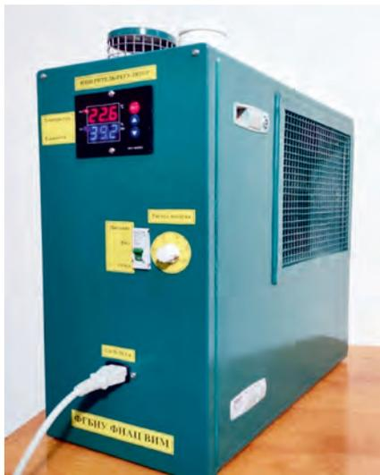
**Рис. 5. Общий вид термоэлектрического осушителя и подогревателя воздуха ТОПВ-100**
