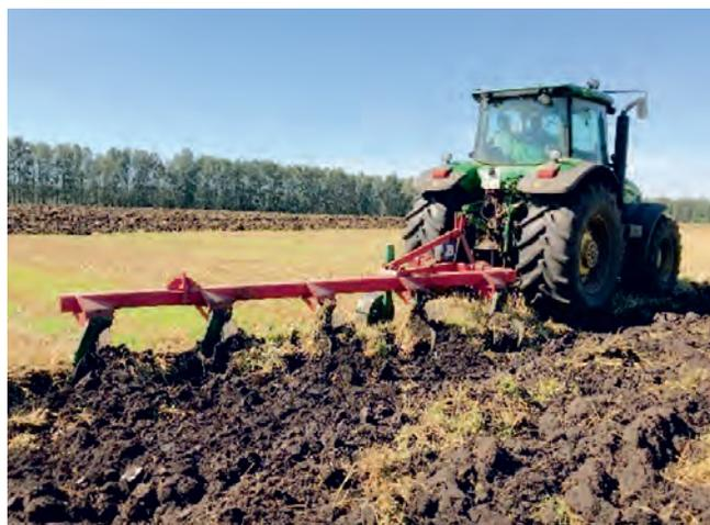
Рис. 1. Почвообрабатывающий агрегат Viking-225
