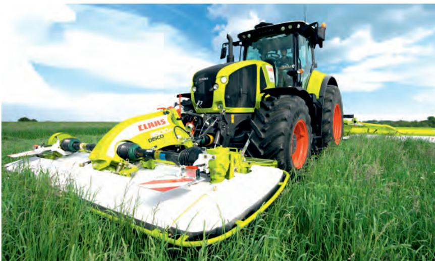
попадание почвы в зеленую массу и добиваться тем самым ее высочайшего качества. Очень широкие скользкие башмаки отводят грязь назад за счет эффекта направляющих. Одновременно они защищают корпус бруса и благодаря необычной форме гарантируют широкую опору и дополнительную стабильность.
