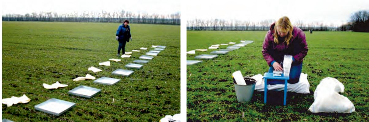
Рис. 1. Расстановка поддонов-пробоотборников и взвешивание удобрений для оценки их содержания по ширине разбрасывания
