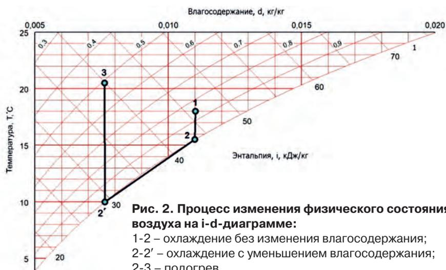
**Рис. 2. Процесс изменения физического состояния воздуха на  $i-d$ -диаграмме:**
