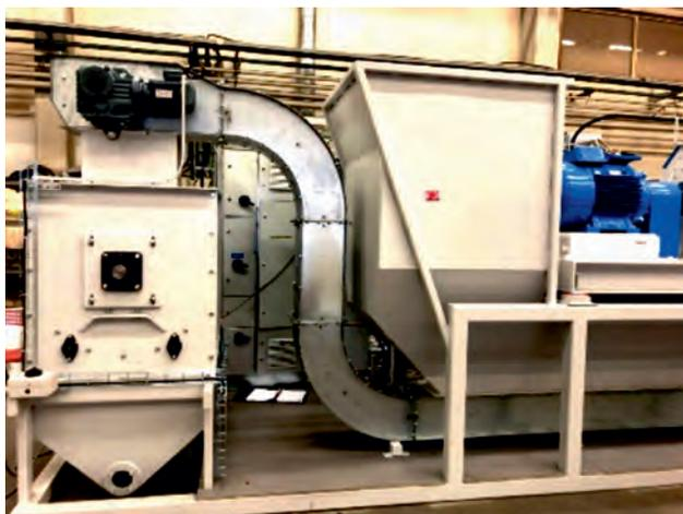
**Рис. 6. Модульный комбикормовый завод FaMix**
