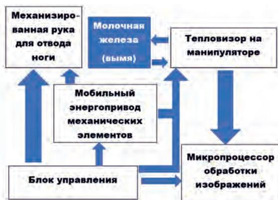
конструкционных элементов комплекса. Мобильный энергопривод обеспечивает энергетическую поддержку механизированной руки для отвода ноги животного, а также осуществляет энергоснабжение манипулятора, на котором закреплено тепловизионное устройство.
