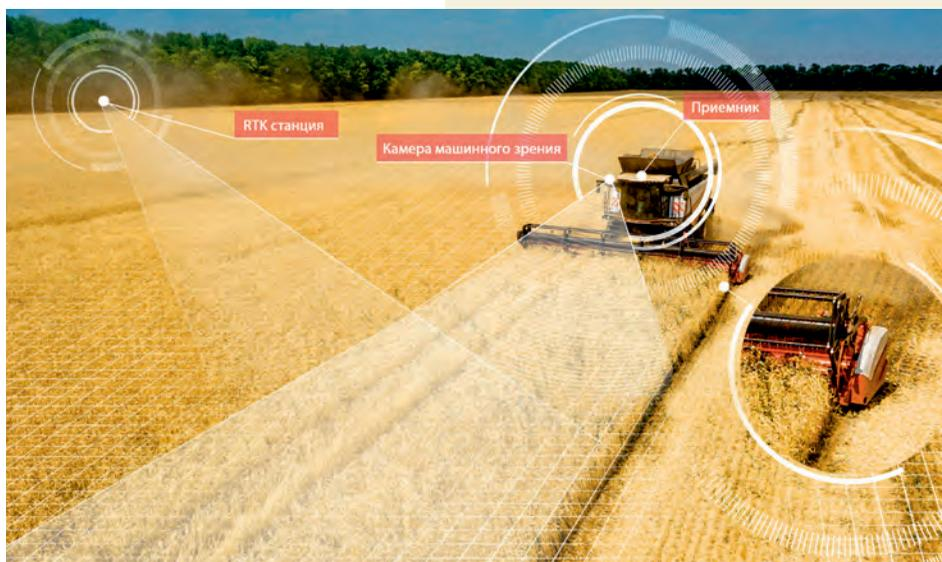
может быть четко идентифицирован на мониторе на расстоянии до 1 км, линии электропередач (ЛЭП) – более 1 км. Система показывает хорошую картинку как с включенными, так и с выключенными фарами. Как подчеркивают разработчики Ростсельмаш, при необходимости систему можно легко перенести и смонтировать на тракторе, комбайне, косилке или самоходном опрыскивателе.
