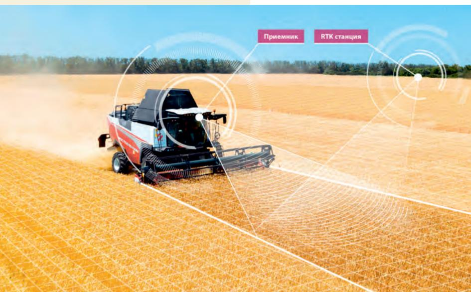
**PCM Агротроник Пилот 2.0** представляет собой первую в мире гибридную систему, сочетающую в себе автоуправление на основе технологий ГНСС, RTK и машинного зрения. Такой подход обеспечивает возможность остановки техники перед внезапно возникшим препятствием.
