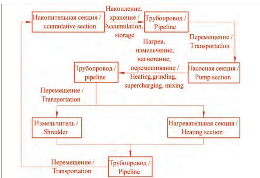
Рис. 2. Схема функционирования установки для приготовления патоки из зерна злаковых культур по пат. 2669297
