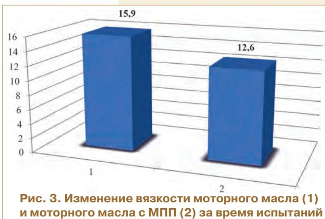
**Рис. 3. Изменение вязкости моторного масла (1) и моторного масла с МПП (2) за время испытаний**
