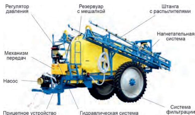
**Рис. 1. Основные конструктивные части опрыскивателя**
