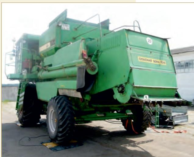
**Рис. 3. Процесс взвешивания комбайна ДОН-1500 Б в варианте комплектации без жатки, с пустым бункером**
