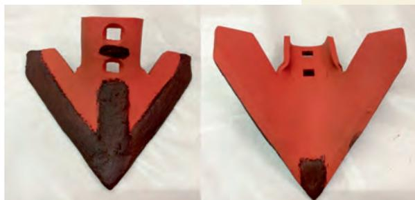
**Рис. 2. Упрочненные лапы, изготовленные в ФНАЦ ВИМ**
