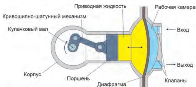
**Рис. 2. Принципиальная схема работы мембранно-поршневого насоса**
