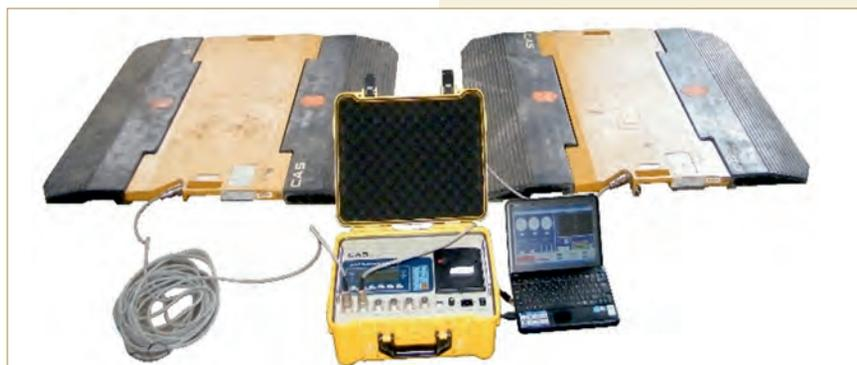
**Рис. 2. Тензометрические весы для определения развесовки зерноуборочной техники**
