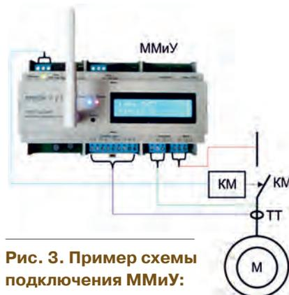
**Рис. 3. Пример схемы подключения ММиУ:** ММиУ – модули мониторинга и управления комплекса; М – электродвигатель; КМ – магнитный пускатель; ТТ – трансформаторы тока; N – нулевой проводник
