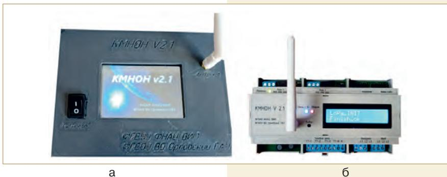
**Рис. 2. Внешний вид элементов КМНОН:** а – сервер КМНОН; б – модуль мониторинга и управления
