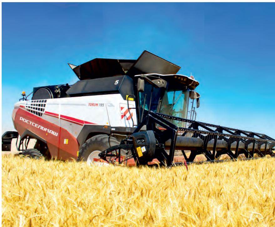
в целом и комбайна TORUM 785 в частности — молотильно-сепарирующее устройство ARS. Уникальная система с двухзаходным ротором и вращающейся декой обеспечивает агромашине одни из самых высоких показателей производительности в своем классе и универсальности среди комбайнов с роторным МСУ. Вращение деки при длине ротора 3200 мм и диаметре 762 мм позволило увеличить площадь обмолота и сепарации до 5,4 м<sup>2</sup> — внушительная цифра. Обмолот выполняется не в одной, а в трех точках.
