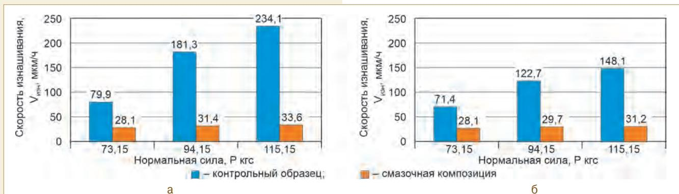
Рис. 1. Зависимость скорости изнашивания колодки от величины нормальной силы при температуре смазочной среды 40 °C (а) и 105 °C (б)
