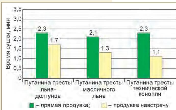
**Рис. 3. Время сушки путанины льна и путанины технической конопля при W = 30-14 %**
