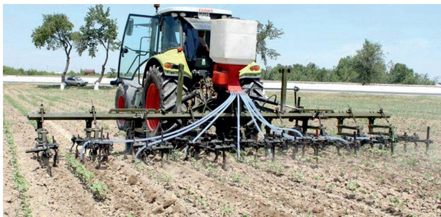
Рис. 4. Культиватор-растениепитатель в работе
