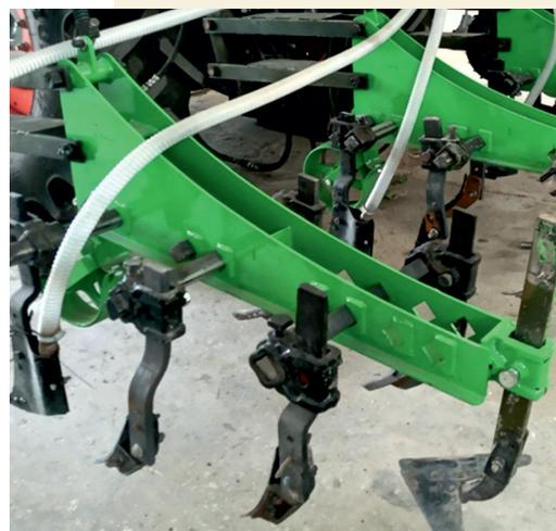
**Рис. 2. Грядиль секции в сборе с рабочими органами**
