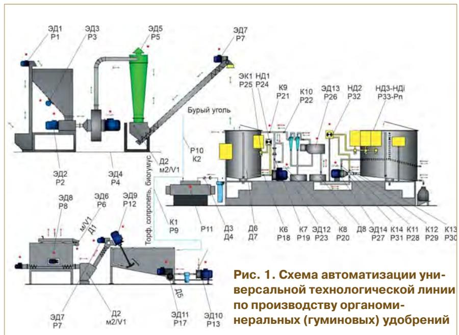
**Рис. 1. Схема автоматизации универсальной технологической линии по производству органоминеральных (гуминовых) удобрений**
