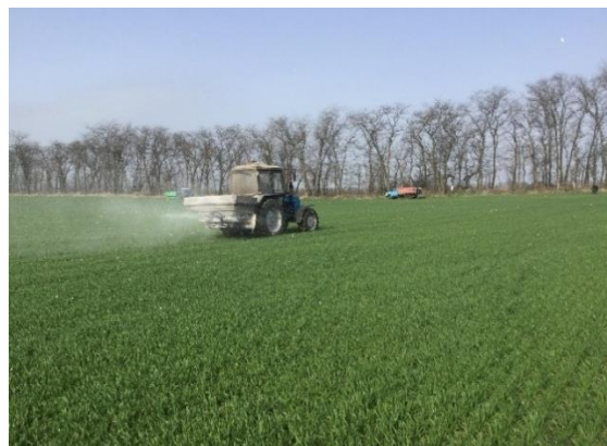
Рисунок 4 – Заправка разбрасывателя Vogballe M2 base и технологическая операция по внесению минеральных удобрений
