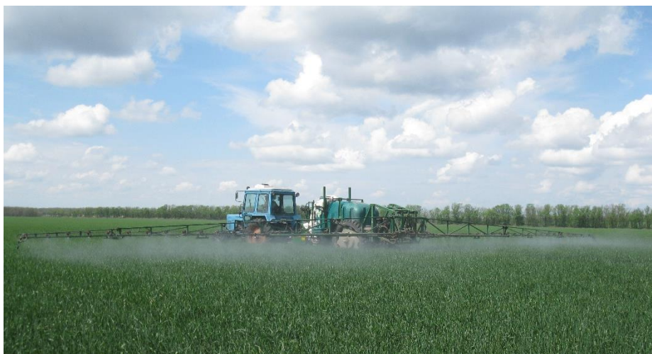
Рисунок 6 – Агрегат МТЗ-82+ОПГ-3000 на опрыскивании посевов озимой пшеницы по вариантам опыта в фазу выхода в трубку
