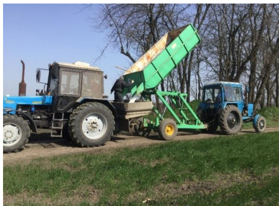
Рисунок 4 – Заправка разбрасывателя Vogballe M2 base и технологическая операция по внесению минеральных удобрений
