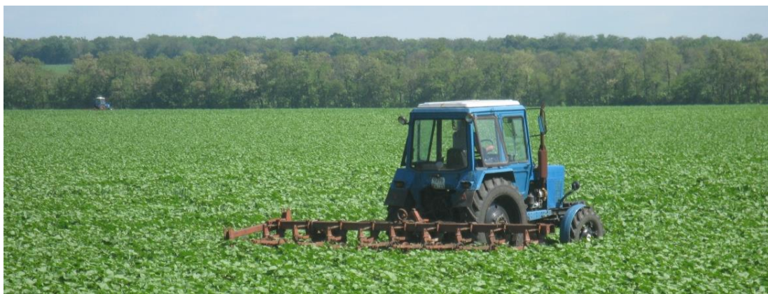
Рисунок 3 – Вторая междурядная культивация подсолнечника агрегатом МТЗ-82+КРН-5,6
