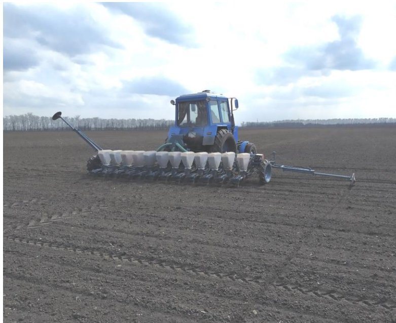
Рисунок 18 – Сеялка УПС-8 в агрегате с трактором МТЗ-82 в работе (посев вариантов опытов)
