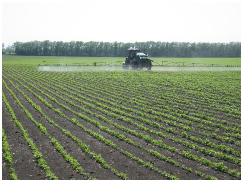
Рисунок 21 – Агрегат МТЗ-82+ОПГ-3000/24МК «Гварта 5» на листовой обработке сои
