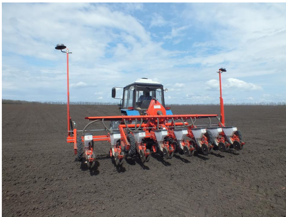
Рисунок 9 – Посев кукурузы на зерно по вариантам опыта агрегатом МТЗ 1025.2 + Planter
