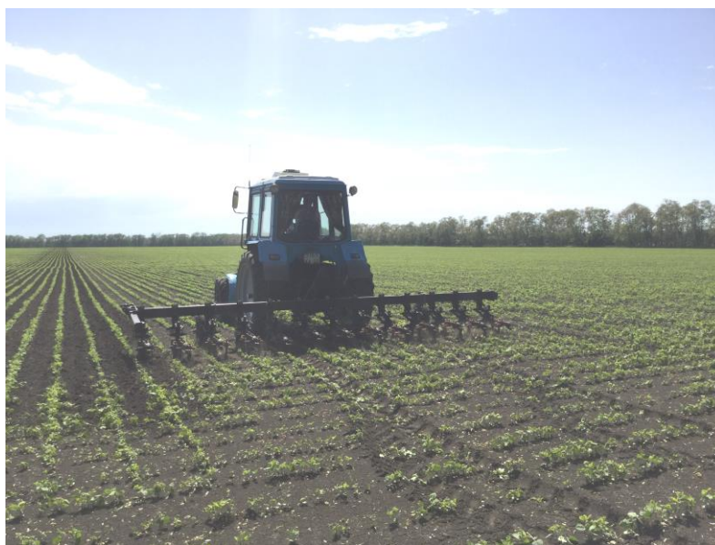
Рисунок 20 – Общий вид агрегата МТЗ-82+УСМК-5,4 на первой междурядной обработке
