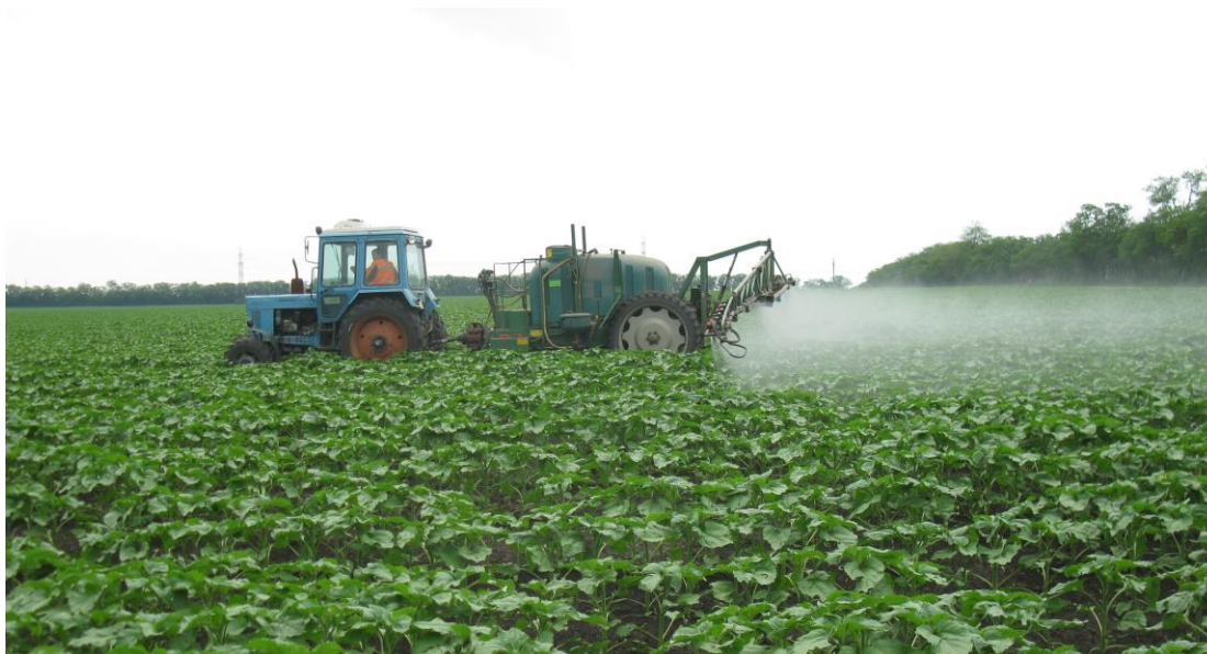
Рисунок 4 – Вторая листовая обработка подсолнечника агрегатом МТЗ-82+ОПГ-3000 «Гварта 5»
