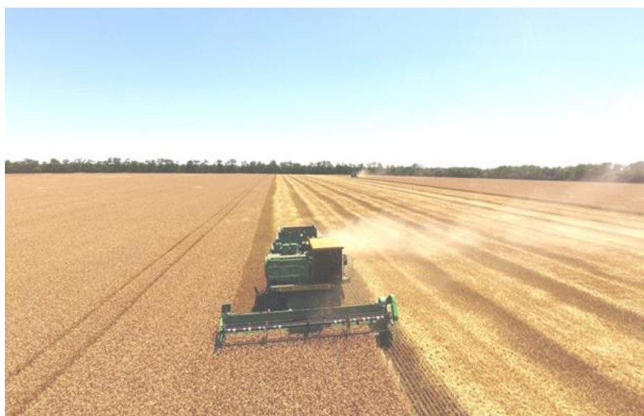
Рисунок 8 – Работа комбайна Дон-1500Б в новом варианте с 7-метровой жаткой при ее рабочей ширине 5,9 м
