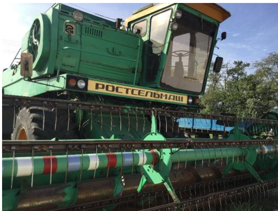
Рисунок 3 – Разметка вала мотовила комбайна Дон-1500Б
