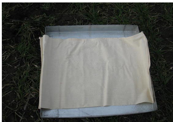
Рисунок 4 – Поддон-пробоотборник для отбора проб ГМУ
