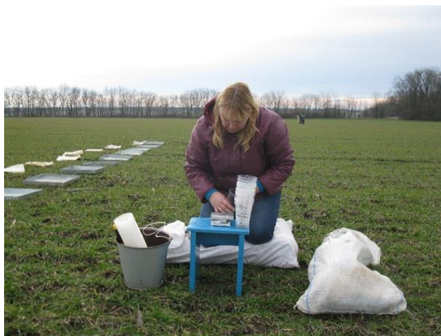
Рисунок 10 – Взвешивание удобрений из поддонов-пробоотборников
