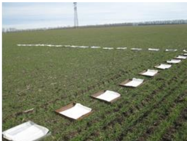
Рисунок 9 – Расстановка поддонов-пробоотборников для оценки продольной (А) и поперечной (Б) неравномерности разбрасывания
