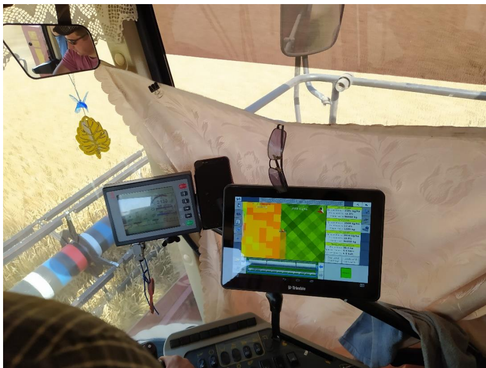
Рисунок 15 – Общий вид монитора Trimble TMX-2050 в кабине зерноуборочного комбайна Полесье GS-12 при картировании урожайности озимой пшеницы
