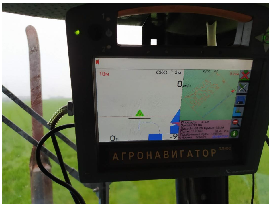
Рисунок 2 – Общий вид карты-задания на дифференцированное внесение аммиачной селитры на мониторе системы «Агронавигатор-АСУР-Дозатор»
