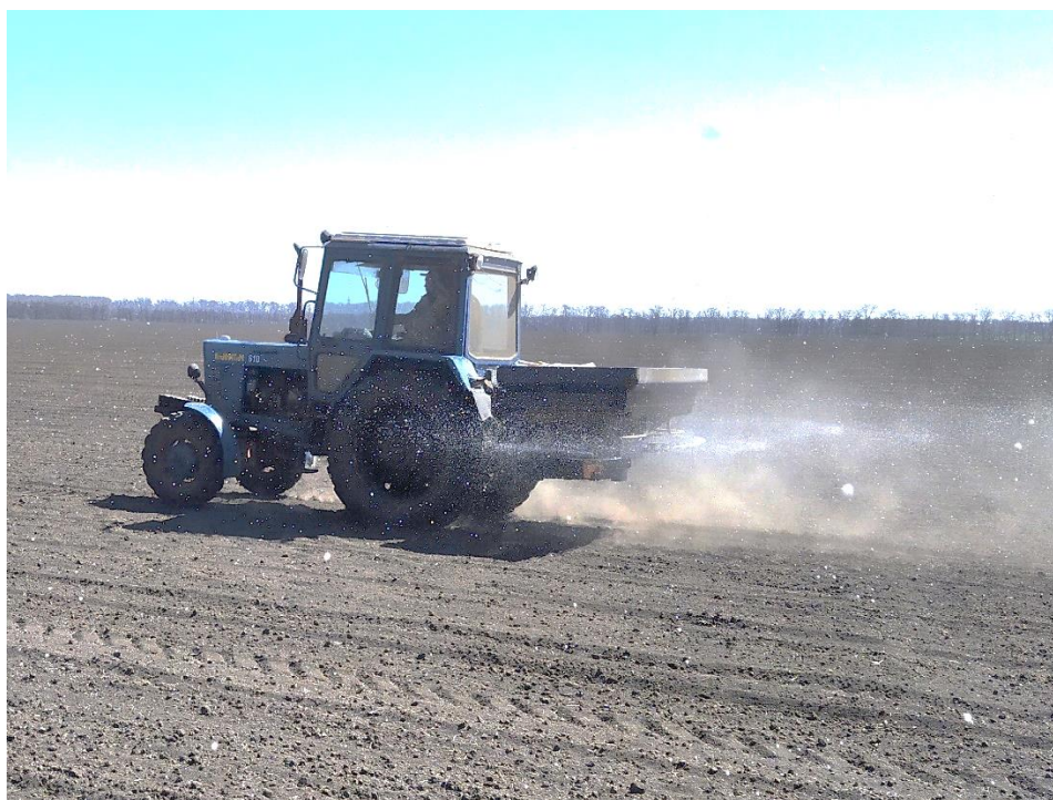
Рисунок 5 – Общий вид разбрасывателя минеральных удобрений Vogballe M2 в агрегате с трактором МТЗ-82 на дифференцированном внесении основной дозы минеральных удобрений после посева кукурузы на зерно
