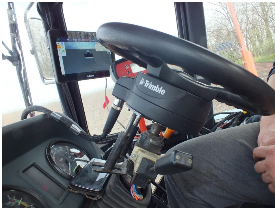
Рисунок 4 – Общий вид системы автоматического вождения Trimble EZ-Pilot+Trimble TMX-2050 в кабине трактора Беларус 1025.2
