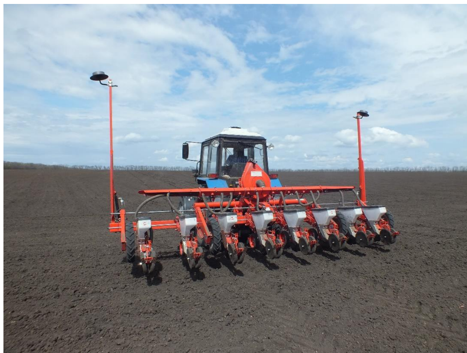
Рисунок 3 – Посевной агрегат Беларусь 1025.2+Kuhn Planter 3, оборудованный системой автоматического вождения Trimble EZ-Pilot+Trimble TMX-2050
