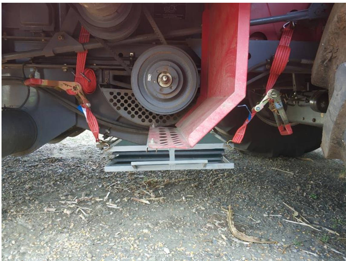
Рисунок 12 – Смонтированный расстановщик пробоотборников РМ-234 под комбайном
