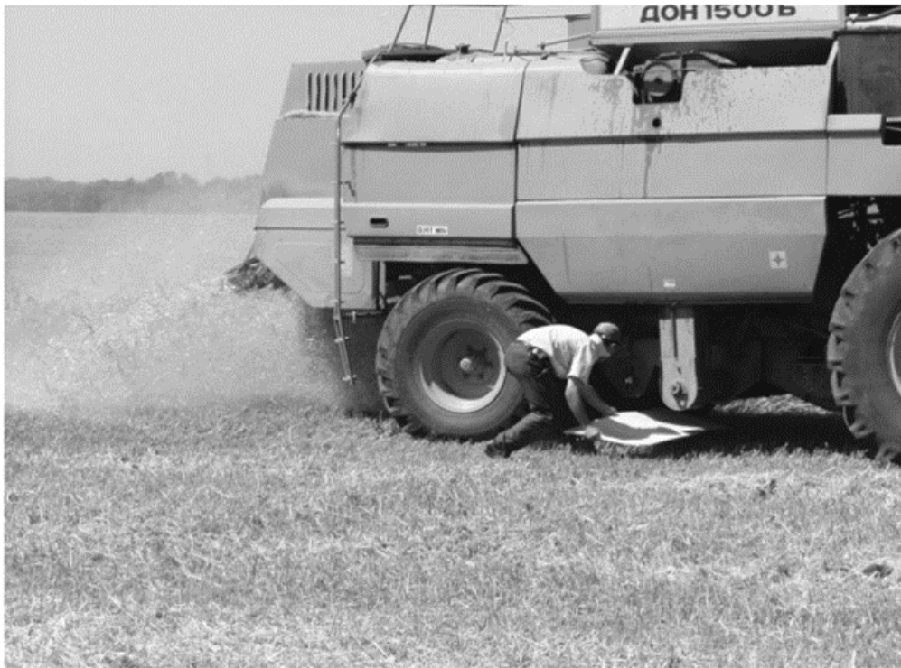
Рисунок 5 – Процесс установки пробоотборника под комбайн
