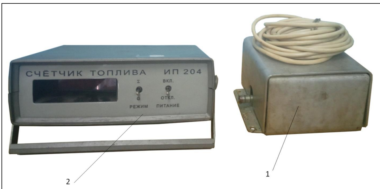
1 – датчик расходомера; 2 – электронный блок регистрации сигналов датчика
