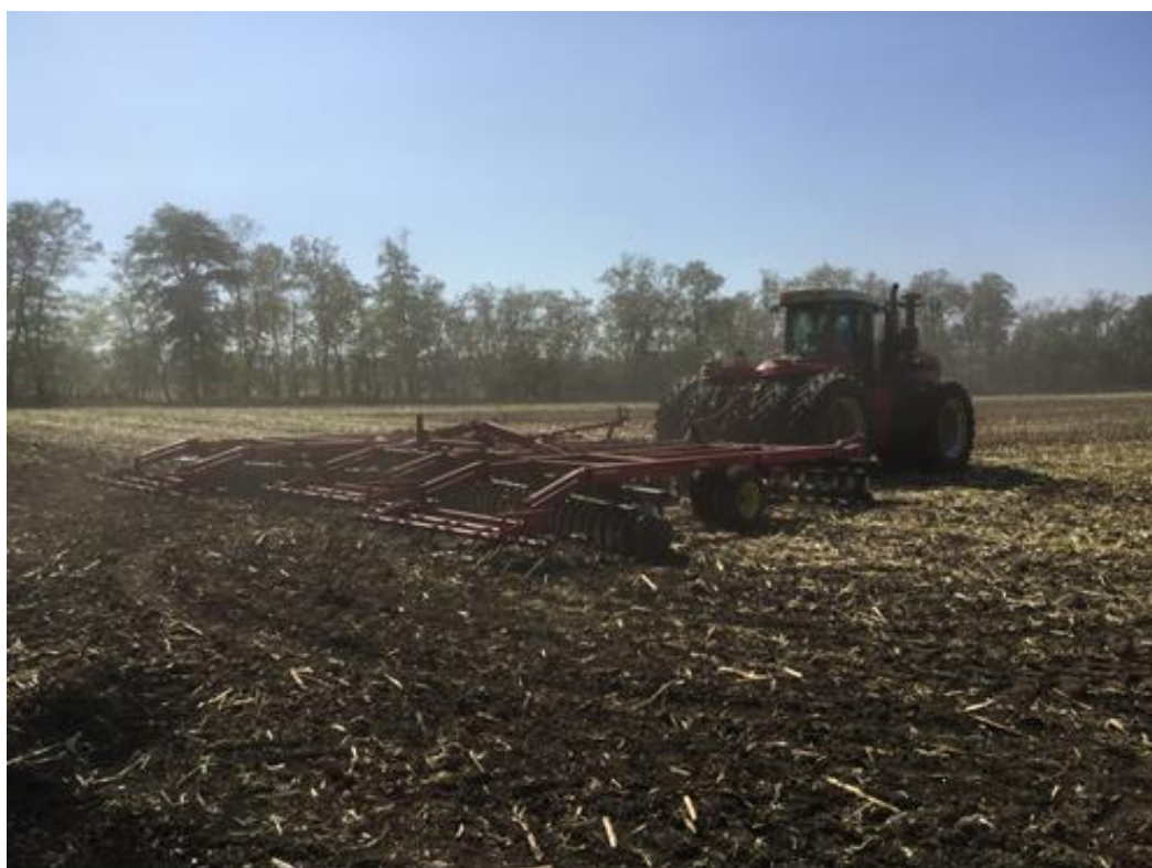
Рисунок 30 – Дисковая борона Challenger Sunflower 1435-29 в агрегате с трактором Versatile 2375 на лущении пожнивных остатков кукурузы
