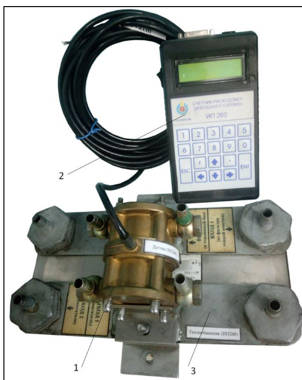
1 – датчик расходомера; 2 – электронный блок регистрации сигналов датчика; 3 – теплообменник
