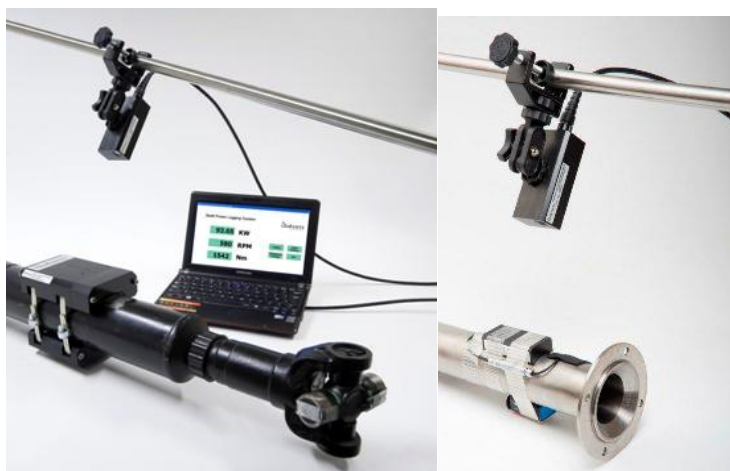
Рисунок А.4 – Комплект для измерения мощности на валу Datum 430
