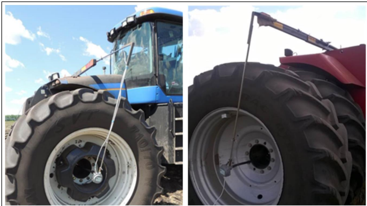
Рисунок 8 – Установка датчиков угла поворота на ведущие колеса тракторов.
