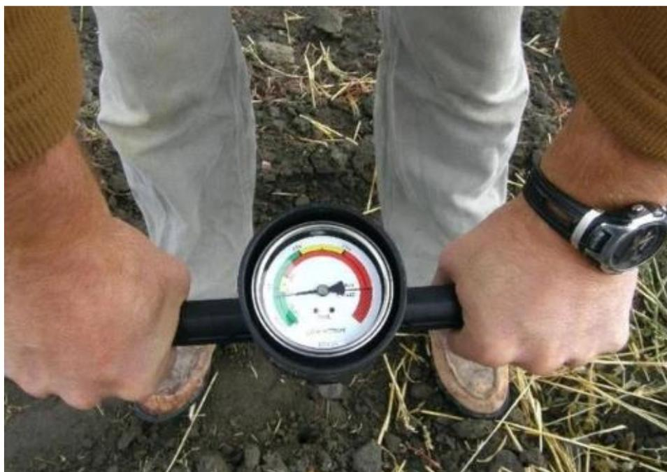
Рисунок А.4 – Измерение твердости почвы пенетрометром Wile Soil
