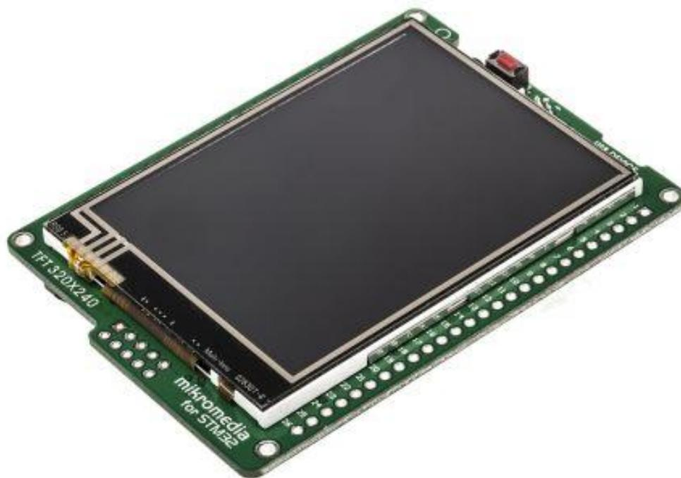
Рисунок 13 – Мультимедийная плата «Mikromedia M4»
