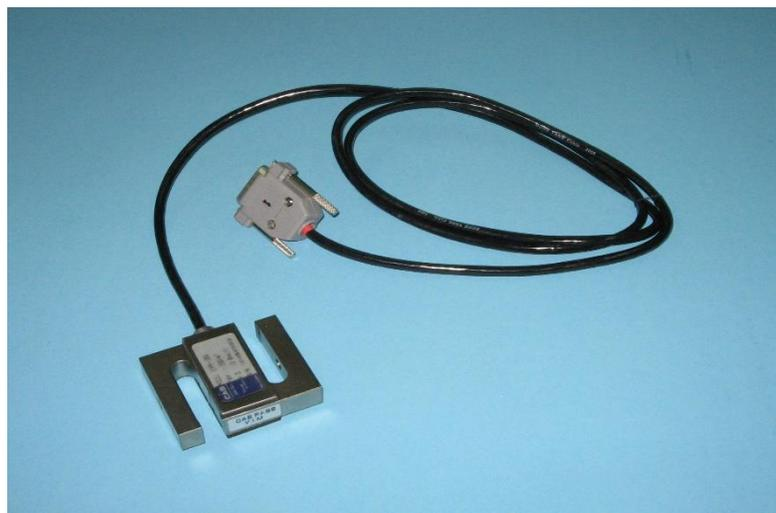
Рисунок 7 – Тензометрический датчик силы на 100 кг
