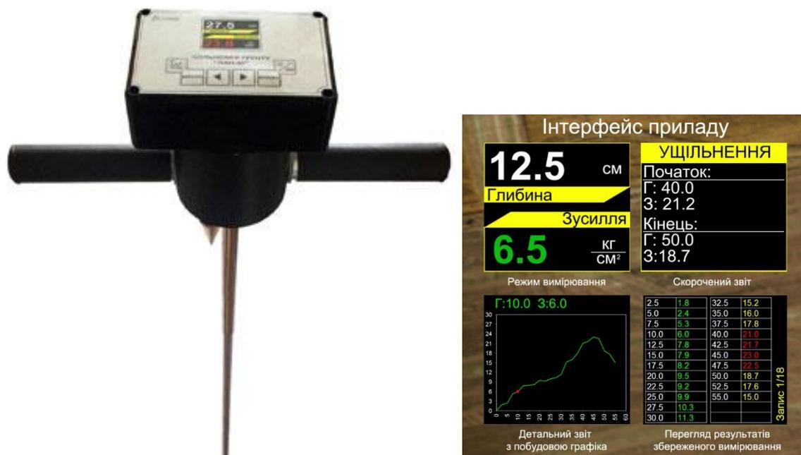
Рисунок А.3 – Плотномер почвы «ЛАН-М»
