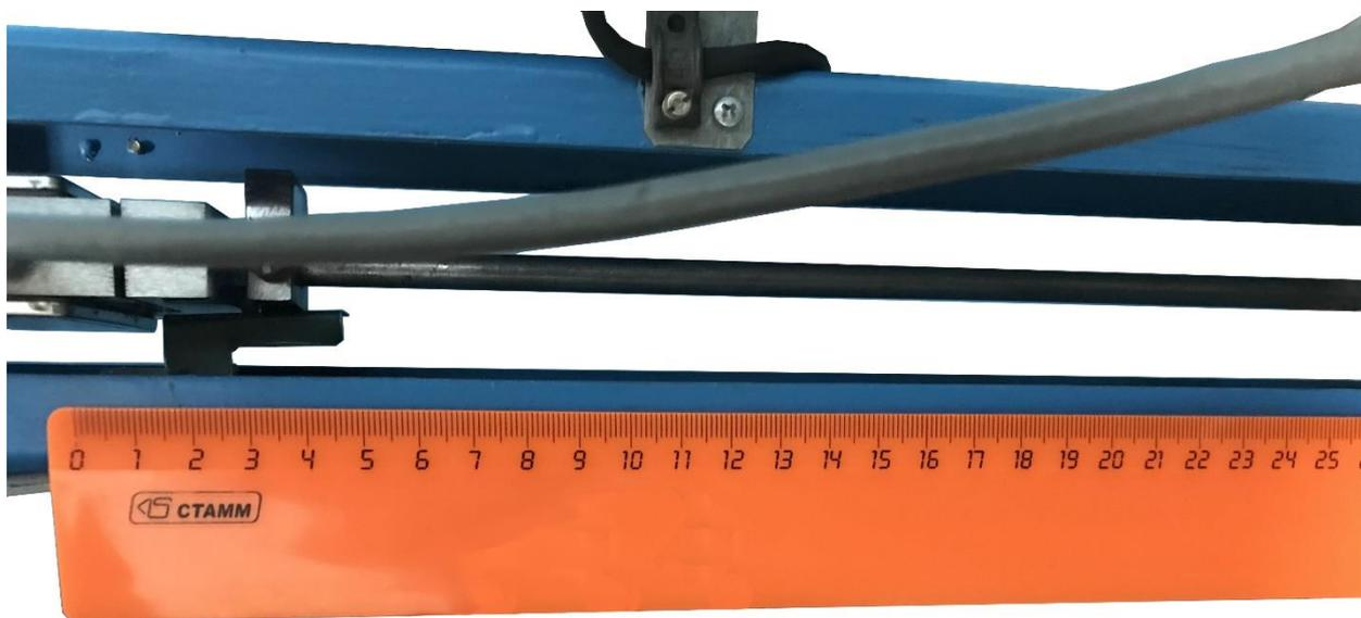
Рисунок 31 – Оценка точности измерения перемещения плунжера
