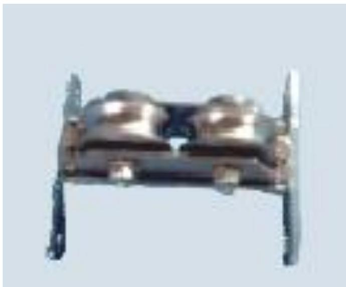
Рисунок 8 – Кронштейн с направляющими роликами
