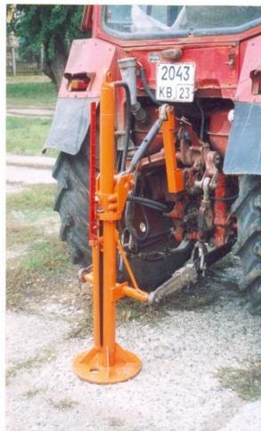
а) общий вид устройства твердомера ИП-267
