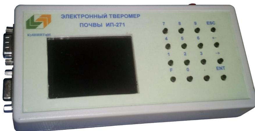
Рисунок 12 – Электронный блок управления твердомера почвы
