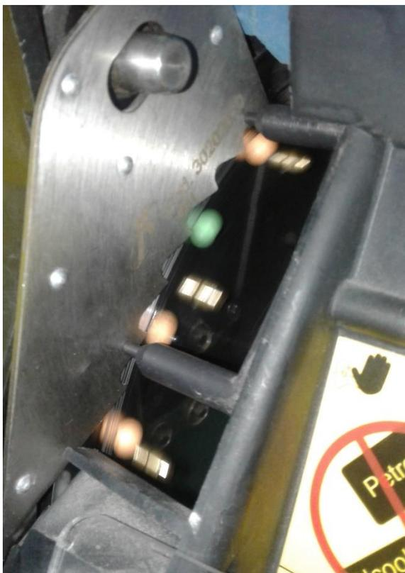
Рисунок 20 – Сферы-имитаторы семян, удерживаемые пневмовакуумом насоса в отверстиях диска при моделировании работы высевающего аппарата сеялки фирмы Mater Mass (мод. 3XL)
