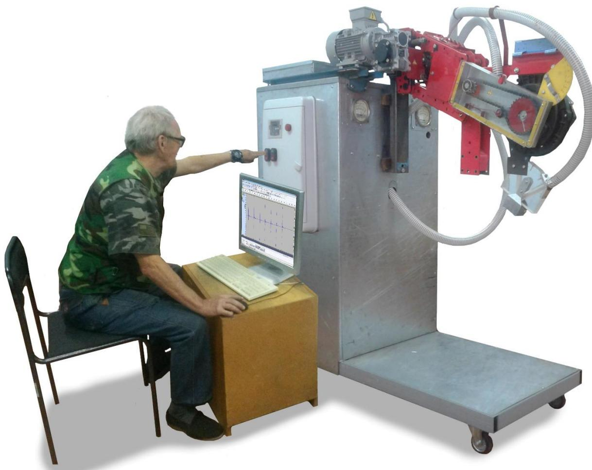
Рисунок 16 – Фрагмент проведения лабораторных исследований работоспособности разработанного специализированного оборудования для определения характеристик высевающих аппаратов сеялок точного высева
