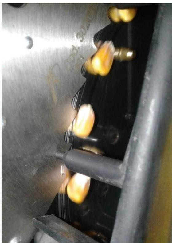
Рисунок 23 – Семена кукурузы, удерживаемые пневмовакuumом насоса в отверстиях диска, при моделировании работы высевяющего аппарата сеялки фирмы Mater Масс (мод. 3XL)
