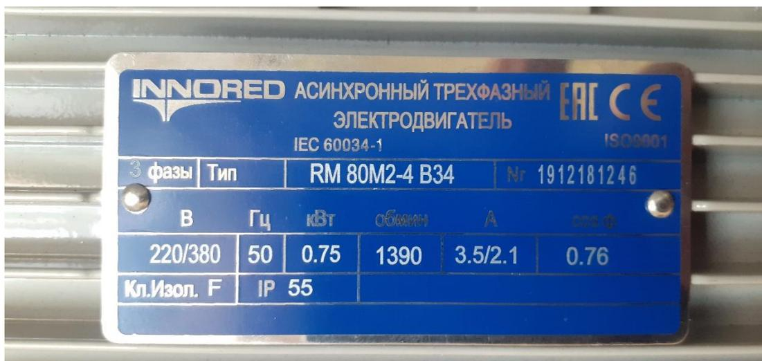
Рисунок 4 – Характеристика асинхронного трехфазного двигателя
