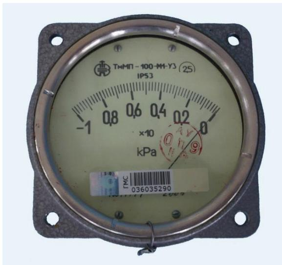
Рисунок 6 – Вакуумметр ТММП – 100 – У3 IP53
