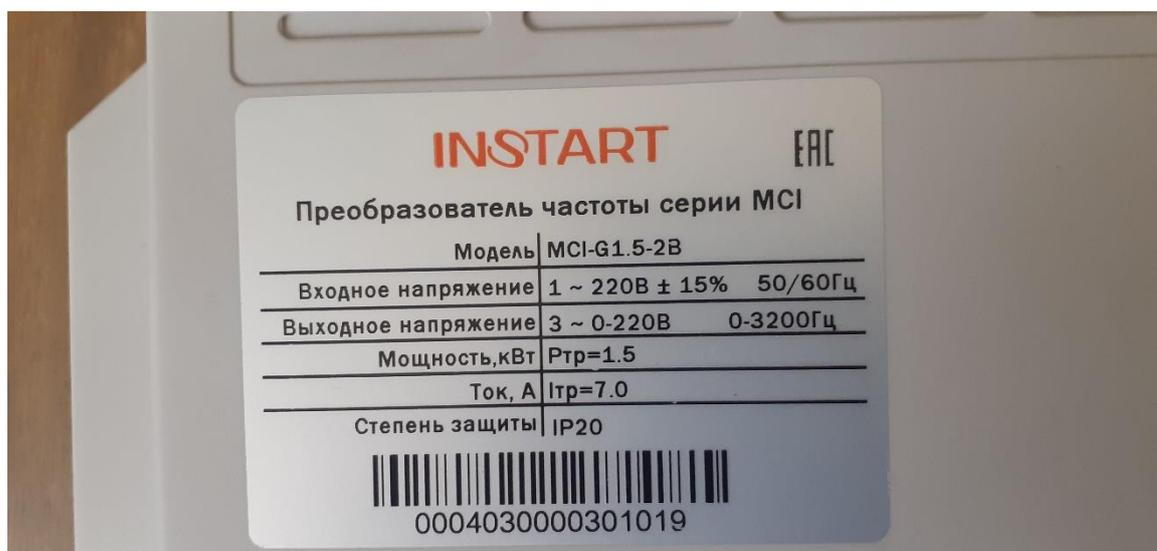
Рисунок 9 – Характеристика преобразователя частоты
