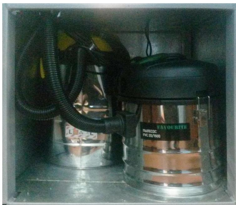
Рисунок 11 – Отсек с расположенными в нем вакуумными насосами
