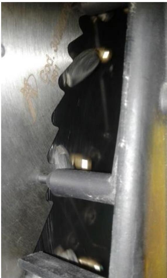
Рисунок 29 – Семена подсолнечника, удерживаемые пневмовакуумом насоса в отверстиях диска, при моделировании работы высевающего аппарата сеялки фирмы Mater Mass (мод. 3XL)
