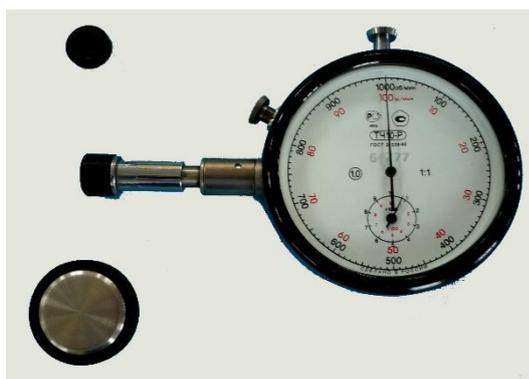
Рисунок 14 – Тахометр ТЧ 10 – Р ГОСТ 20339-82
