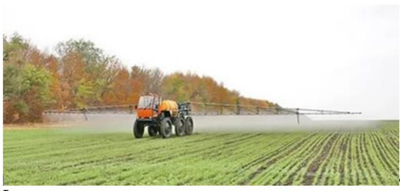
Рисунок 3 – Самоходный штанговый опрыскиватель в технологическом процессе краевой обработки полей от сорняков и вредителей
