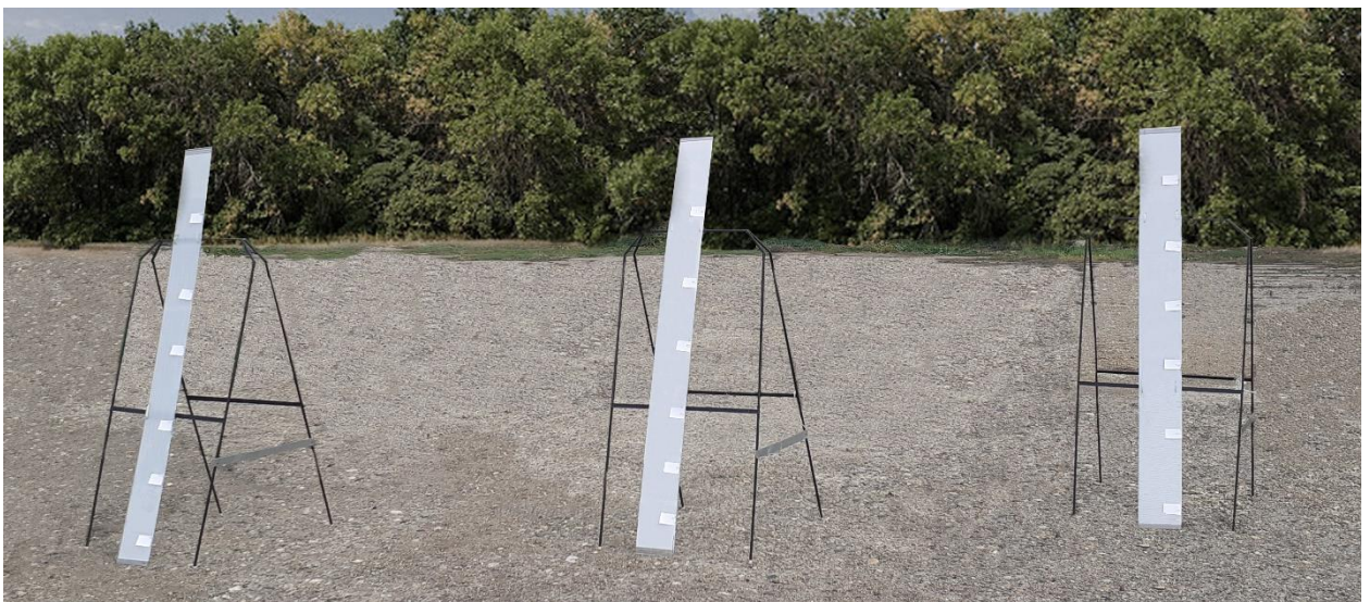
Рисунок Б.2 – Расстановка планшетов по отношению к краю конического сопла технического средства на расстояниях, принятых равным 4, 5 и 6,5 м
