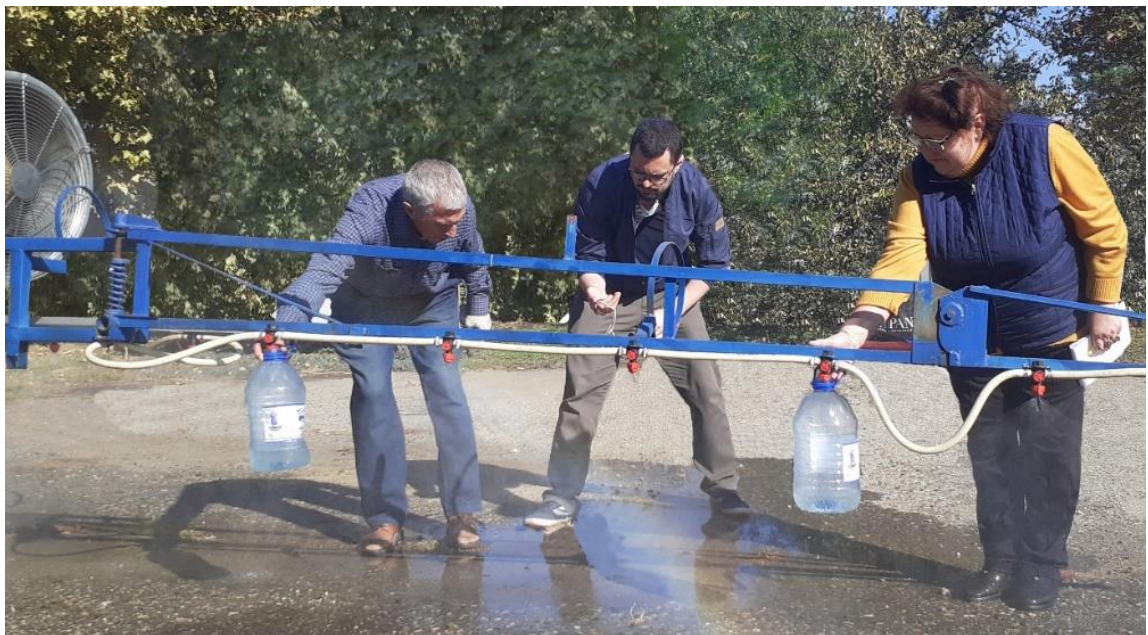
Рисунок 19 – Определение расхода воды ее сбором из распылителей
