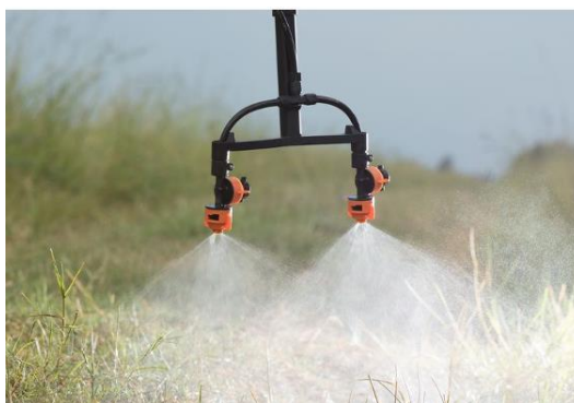
а) плоские факелы распыла жидкости от сопел щелевых распылителей, установленных на штанге опрыскивателя
