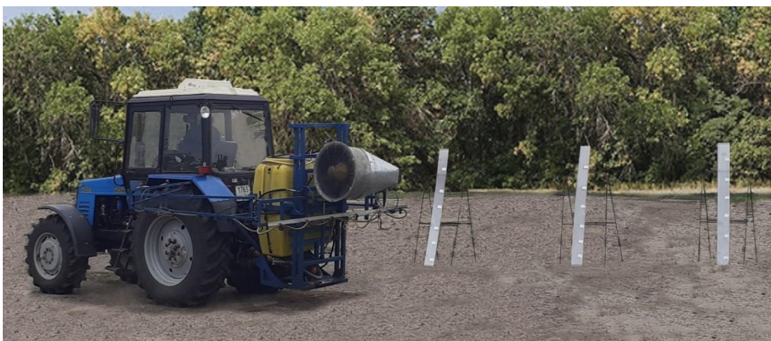
Рисунок Б.3 – Нанесение капель на карточки из воздушно-капельного потока, создаваемого подачей факелов распыла щелевыми распылителями в воздушный поток начального участка струи
