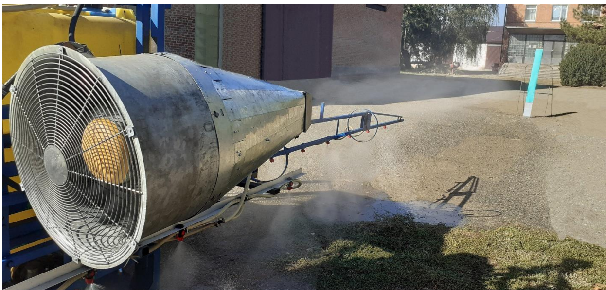
Рисунок 14 – Качественная оценка распространения воздушно-капельной системы за пределами края штанги навесного опрыскивателя
