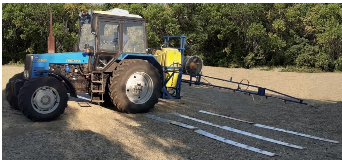
Рисунок 17 – Опрыскивание карточек щелевыми распылителями, установленными на навесной штанге опрыскивателя
