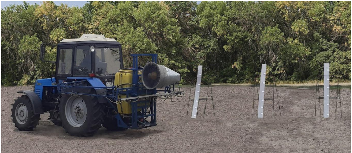
Рисунок 18 – Нанесение капель на карточки из воздушно-капельного потока, создаваемого подачей факелов распыла щелевыми распылителями в воздушный поток начального участка струи
