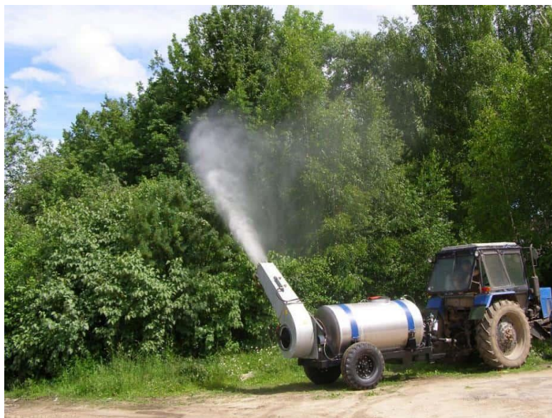
Рисунок 4 – Общий вид рабочего процесса опрыскивания лесополосы опрыскивателем центробежного принципа действия
