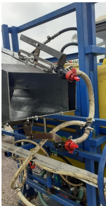
Рисунок 24 – Турбопенные всасывающие сопла фирмы «Lechler» (тип сопла – ID, IDK, IDKN, LU, AD, ST, DF (60M – 04), код цвета – красный) в составе конического сопла устройства
