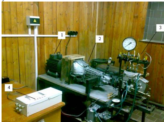
Рисунок 6. Установка для испытания и технического обслуживания топливной аппаратуры СМТА-01: 1 – Электродвигатель; 2 – Коробка передач; 3 – Комплект топливной аппаратуры; 4 – Прибор ПУиСО-01
