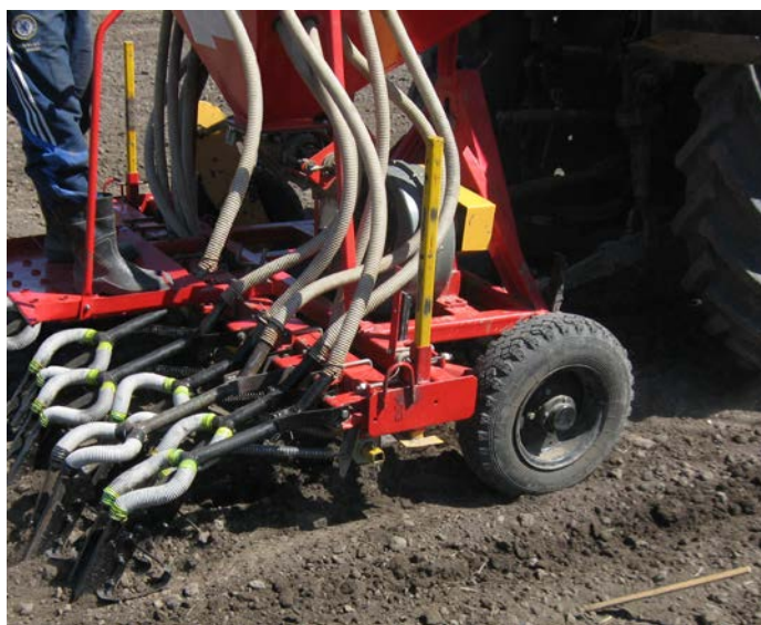
Рисунок 9 – Сеялка ССНП-16, оборудованная экспериментальными двухстрочными килевидными сошниками
