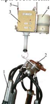
Рисунок 12 – Общий вид экспериментально-го образца безопасного,стимулирующего доильного аппарата АДС-1СЭаУ:
