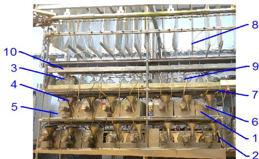
Рисунок 1- Внешний вид лабораторных установок. Объемы метантенков - 17 л.1 - цилиндр объемом 0,02 м 3 ; 2 - водяная рубашка 3- водяной котел 4 - патрубков для загрузки сырья; 5 - выгрузочный патрубок 6 - электрический привод с частотой вращения 60 об/мин; 7 - гибкие газовые трубы d=8мм.; 8 – газгольдер; 9 - водяной фильтр; 10 - сенсоры для определения объема CH 4 , CO 2 и H 2 S, а также датчики температуры и давления.
