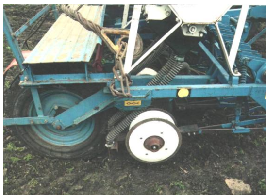
Рисунок 16 а, б – Общий вид модернизированной посевной секции
