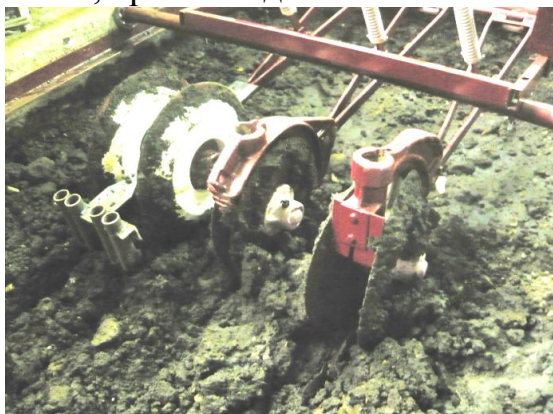
Рисунок 14 – Работа предлагаемых (слева) и традиционных (справа) бороздообразующих устройств в переувлажненной почве
