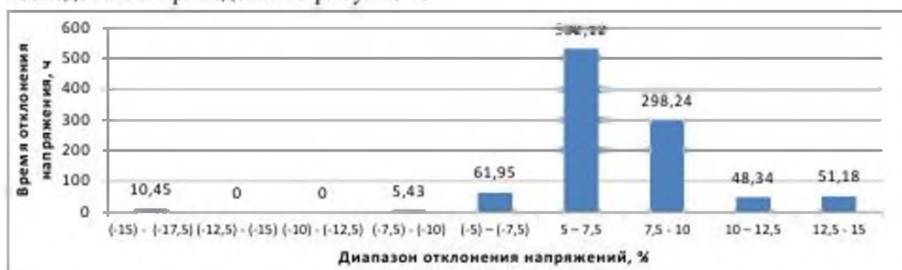
Рисунок 4 – Время отклонения напряжения в точках балансового разграничения потребителя и электросетевой организации в зависимости от диапазона отклонения.
