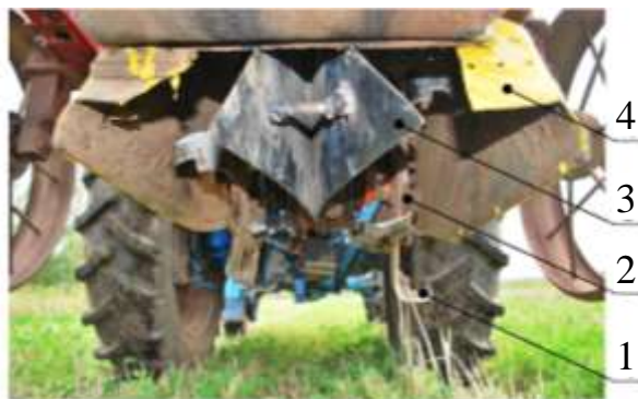
Рисунок 5 – Лабораторно-полевая установка: 1 – L-образный нож; 2 – фреза; 3 – двусторонний отвал; 4 – кожух
