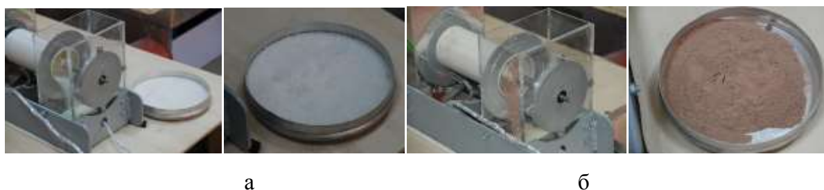
Рисунок 13 – Высев геликоидным дозатором кристаллических (а) и порошкообразных (б) минеральных удобрений
