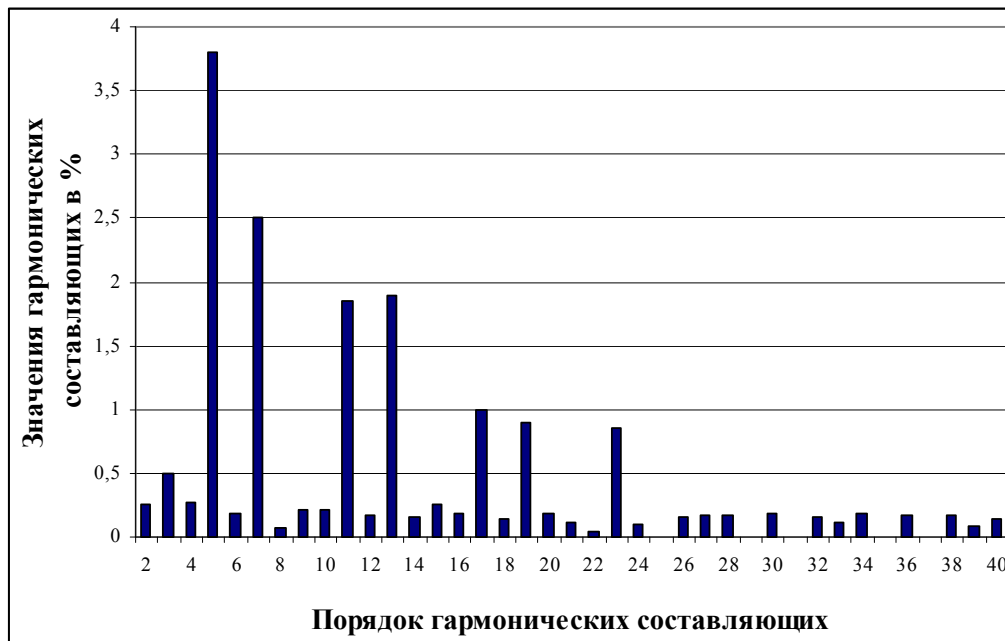
Рисунок 10 – Гармонический состав выходного сигнала преобразователя из трех фаз в одну
