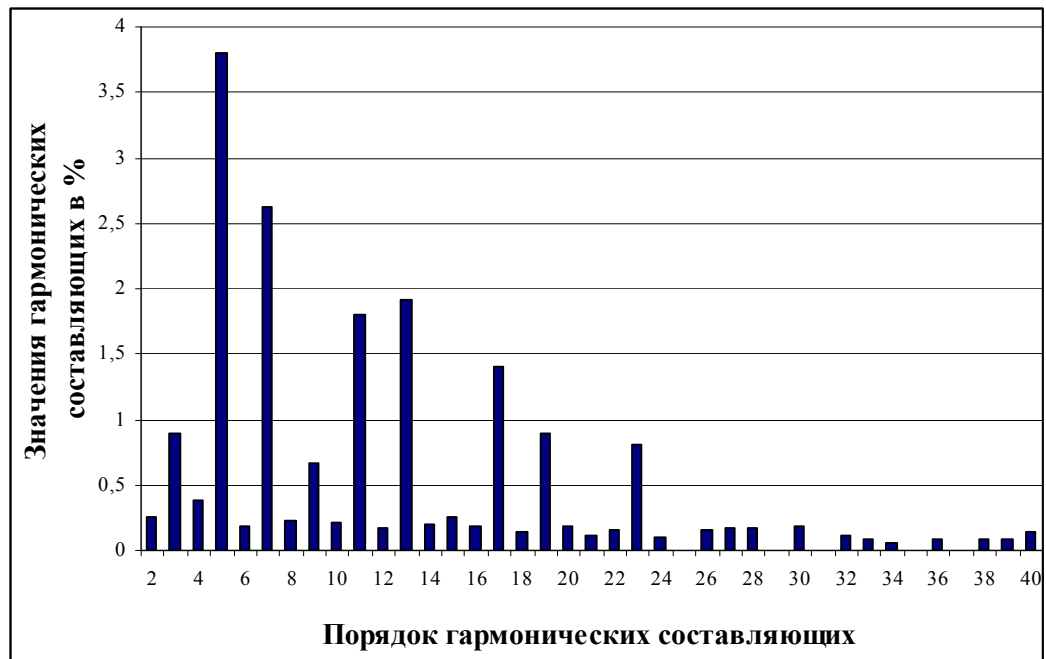
Рисунок 11 – Гармонический состав выходного сигнала преобразователя одной фазы в три
