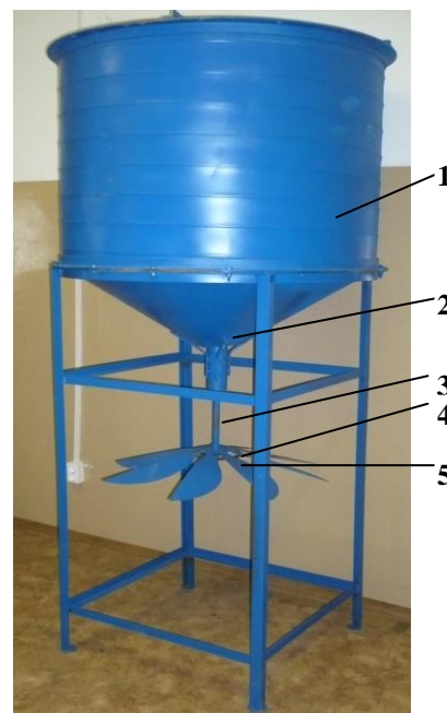
Рисунок 5 – Общий вид экспериментального загрузочно-распределительного устройства: 1- бункер; 2- воронка бункера; 3- ось распределительного устройства; 4- ограничитель; 5- лопасти
