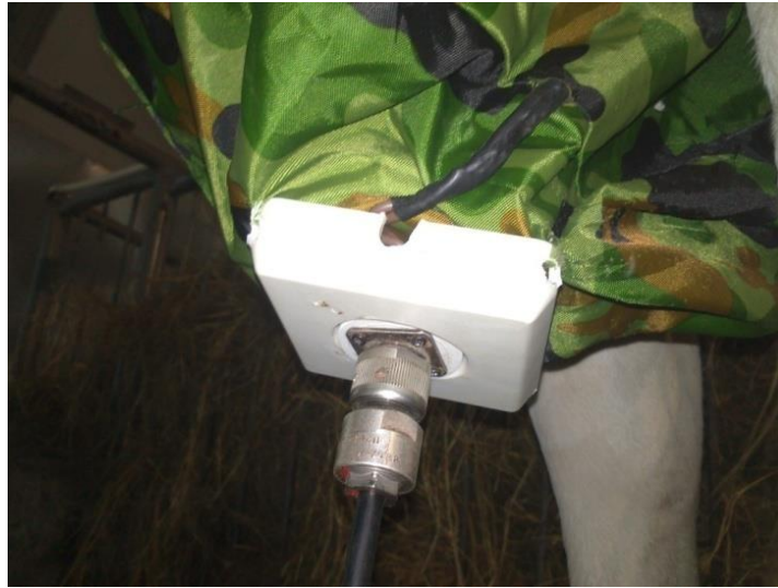
Рисунок 5 – ВЧ соединение электродов для проведения УВЧ-терапии
