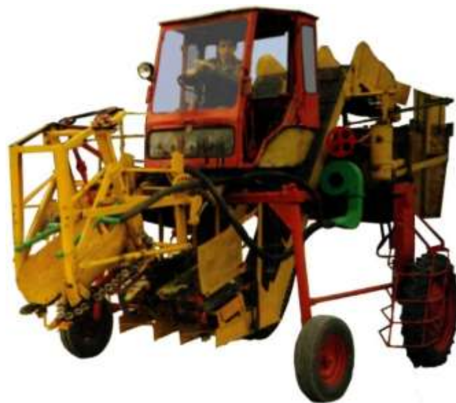
Рисунок 13 - Общий вид экспериментального образца универсального комбайна для уборки листьев табака средних и верхних ломок КТУ – 720
