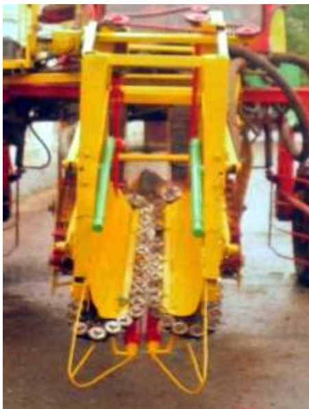
Рисунок 12 -Листоотделительный аппарат универсального комбайна для уборки листьев табака средних и верхних ломок КТУ – 720
