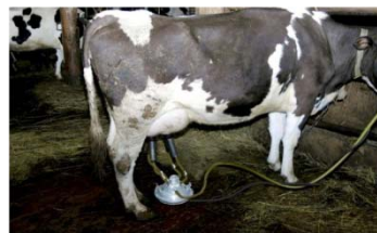
Рисунок - 7 Общий вид коллектора доильного аппарата с независимым вакуумом
