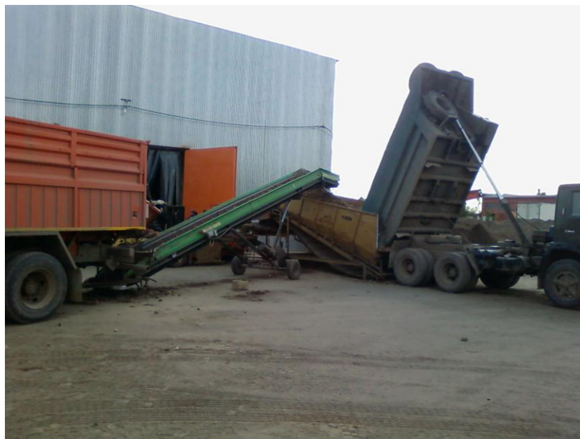
Рисунок 3. Одновременная выгрузка картофеля в приёмный бункер по двухканальной системе: из самосвала и из автомобиля, оборудованного кузовом с подвижным дном
