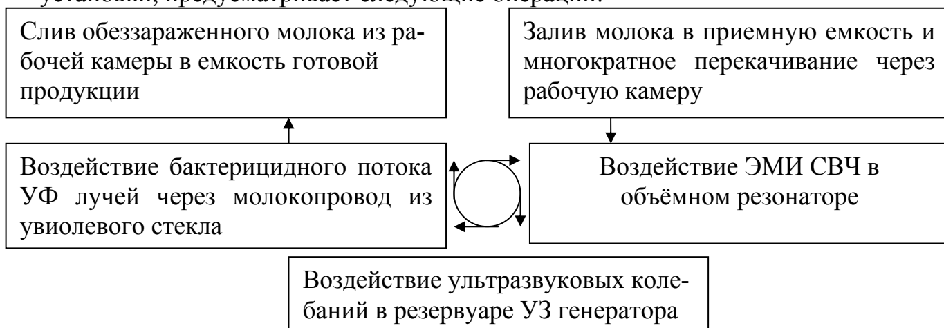
Рисунок 1 - Блок-схема технологического процесса обеззараживания молока комбинированным воздействием электрофизических факторов
