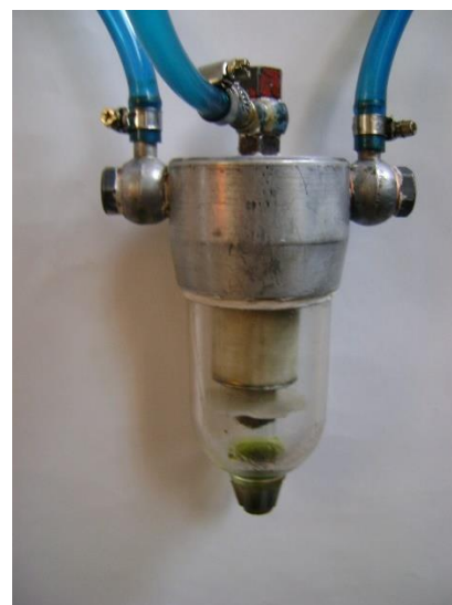
Рисунок 2 – Смеситель-дозатор минерального топлива и растительного масла
