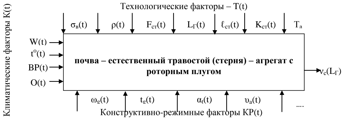
Рисунок 5 – Формализованная модель взаимодействия элементов подсистемы «почва → естественный травостой (стерня) → агрегат с роторным плугом»
