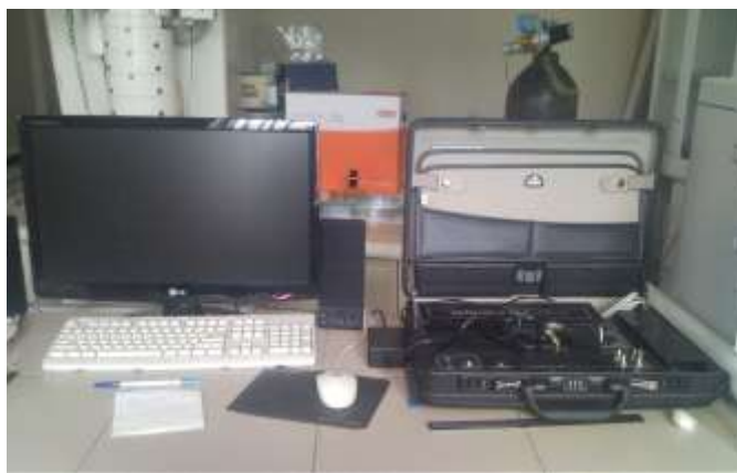
Рисунок 3 - Хроматограф ФГХ-1 использованный для определения состава паровоздушной смеси из баков автотранспортных средств в процессе их заправки
