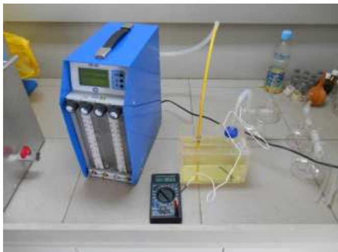
Рисунок 2 - Имитационная модель процесса вытеснения насыщенных паров из баков автотранспортных средств, в процессе их заправки
