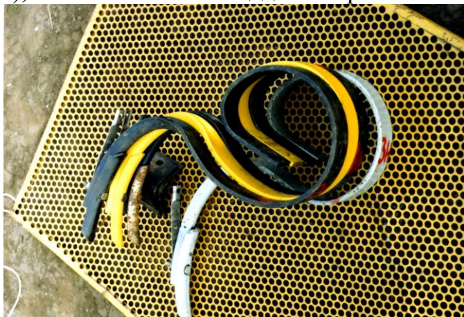
Рисунок 4 – Упругие рыхлители (стойки) «Ж», «3Н», «2Ч» и новый «1К»
