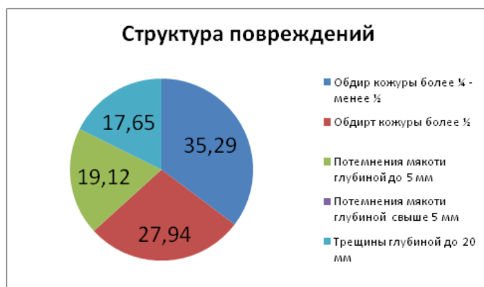
Рисунок 16 – Структура повреждений на вильчатой направляющей
